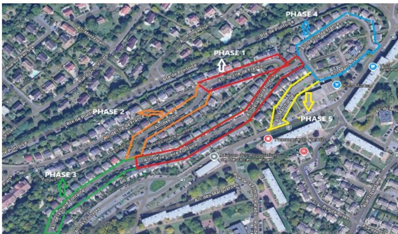
La communauté urbaine GPSEO entreprendra prochainement la rénovation de la voirie de Paradis. Les travaux consisteront à rénover la couche de roulement sur l'ensemble de ces voies et à effectuer des reprises ponctuelles des trottoirs les plus dégradés.
